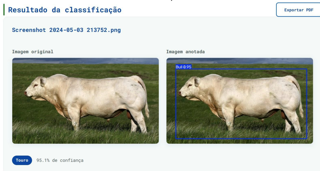
Figura 5: Interface do módulo de classificação do sistema CattleVision, evidenciando a imagem original (esquerda), a imagem anotada com a caixa delimitadora (direita) e a classe predita com o respectivo percentual de confiança.
