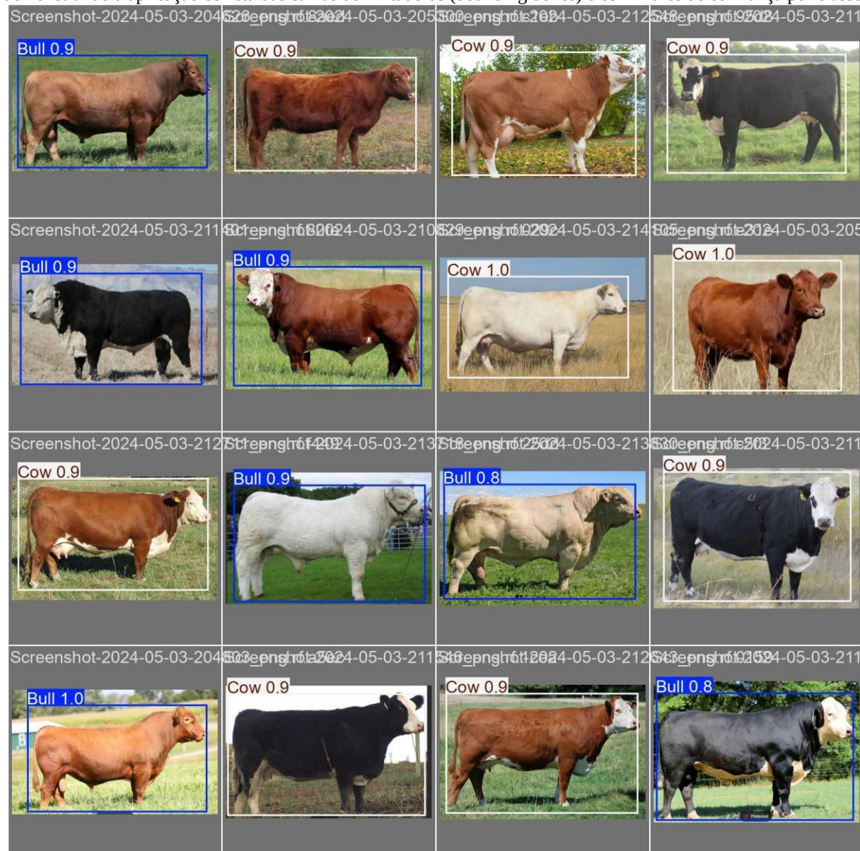
Figura 3: Amostra visual de inferência qualitativa do modelo YOLOv8s em condições de campo aberto, demonstrando a aplicação correta das caixas delimitadoras (bounding boxes) e os limiares de confiança por classe.
