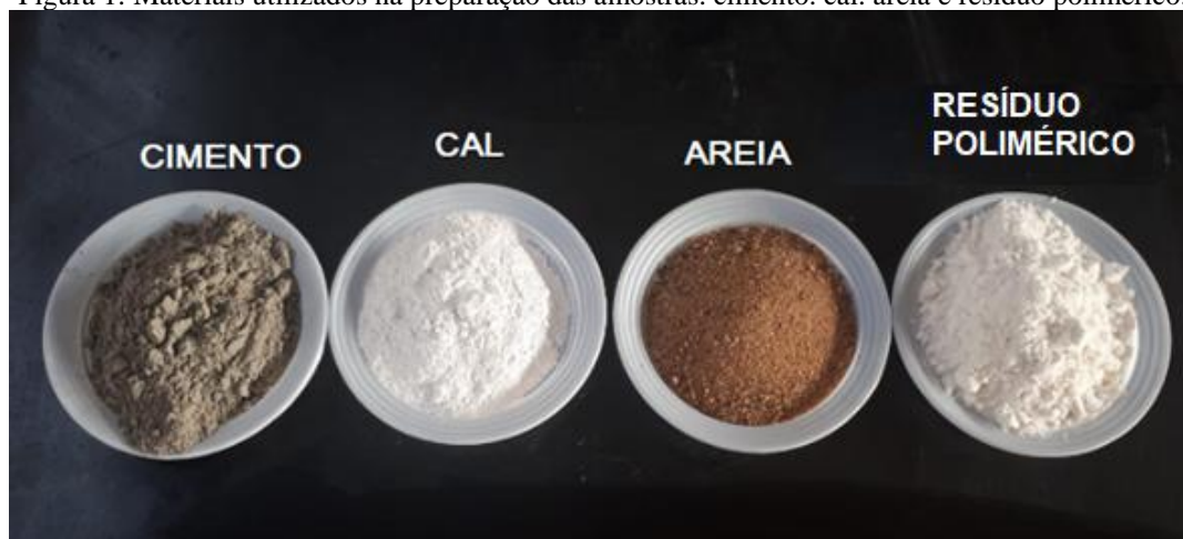
Figura 1: Materiais utilizados na preparação das amostras. cimento. cal. areia e resíduo polimérico.
