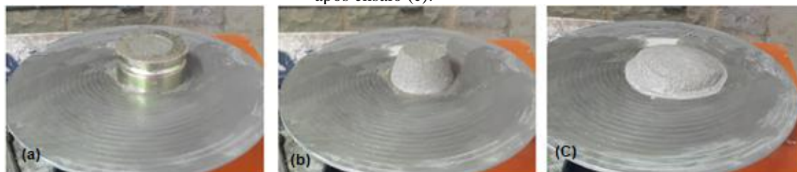
Figura 3: Etapas do ensaio de consistência: Enchimento do cone (a). amostra antes do ensaio (b). amostra após ensaio (c).
