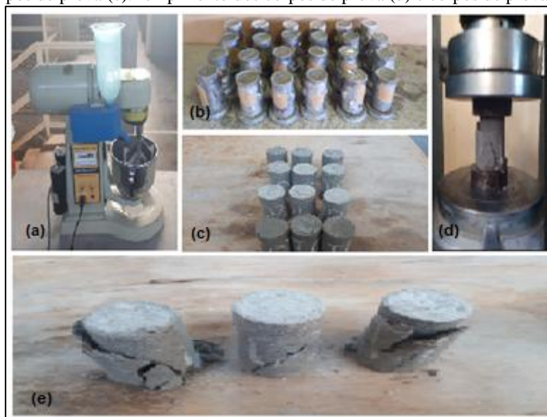
Figura 2: Processo de obtenção dos corpos de prova: Preparação da argamassa (a). moldagem (b). desmoldagem dos corpos de prova (c). rompimento dos corpos de prova (d) e corpos de prova rompidos (e)
