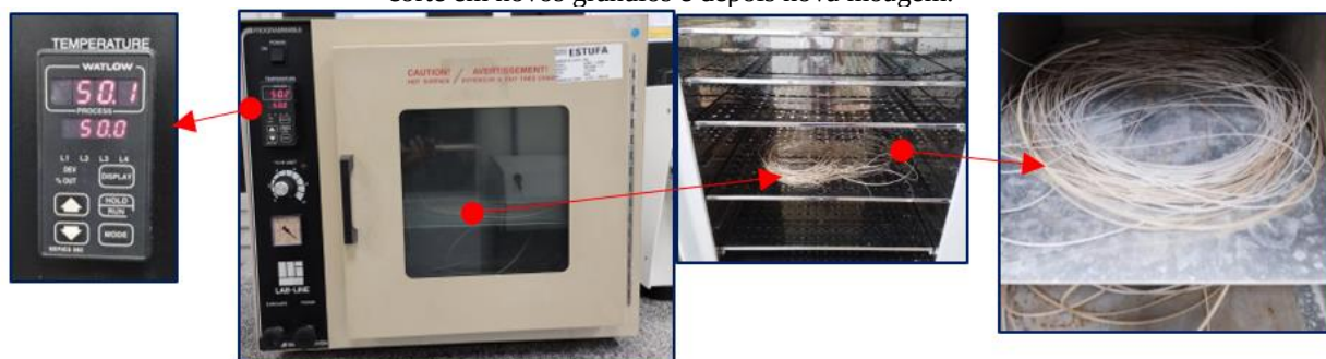
Figura 13. Processo de aquecimento na Estufa, do material compósito FTCN/PET/PP extraído da extrusora, para corte em novos grânulos e depois nova moagem.
