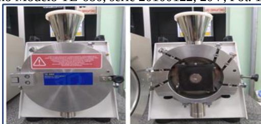
Figura 8. Moinho Modelo TE-680, série 20100122, 20V, Pot. 1100W, Tecnical.
