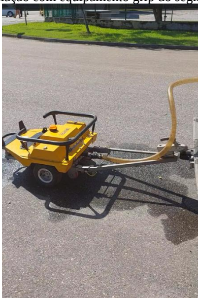
Figura 3 – Avaliação com equipamento grip do segmento com RCD.
