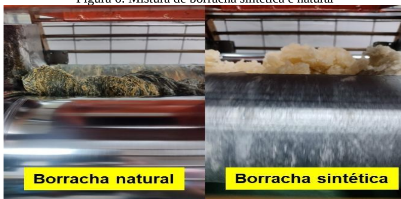
Figura 6: Mistura de borracha sintética e natural
