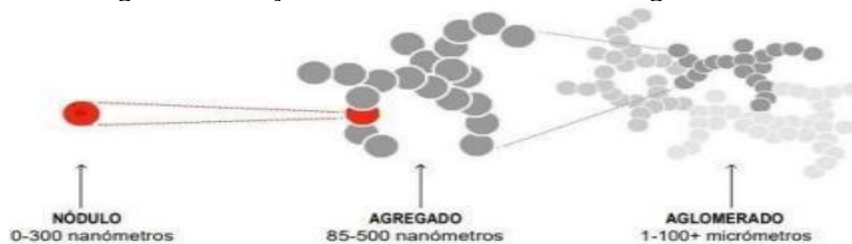
Figura 2: Arranjo de estruturas diferentes do negro de fumo
