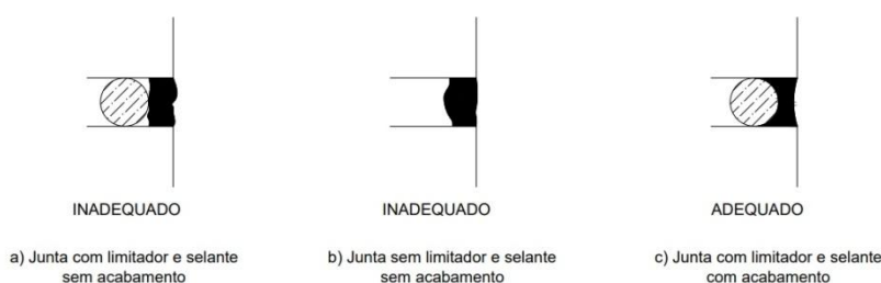
Figura 1 - Configuração Final do Selante nas Juntas de Movimentação segundo NBR 13755
