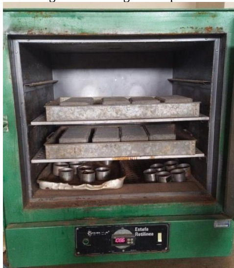
Figura 11 - Secagem dos pavers
