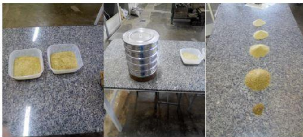
Figura 4 - Ensaio de granulometria do vidro
