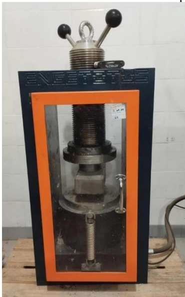
Figura 13 - Ensaio de resistência a compressão
