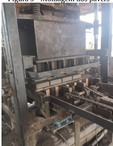
Figura 9 - Moldagem dos pavers
