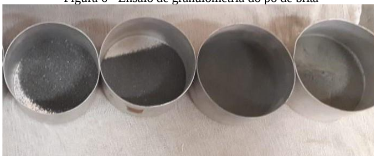
Figura 6 - Ensaio de granulometria do pó de brita
