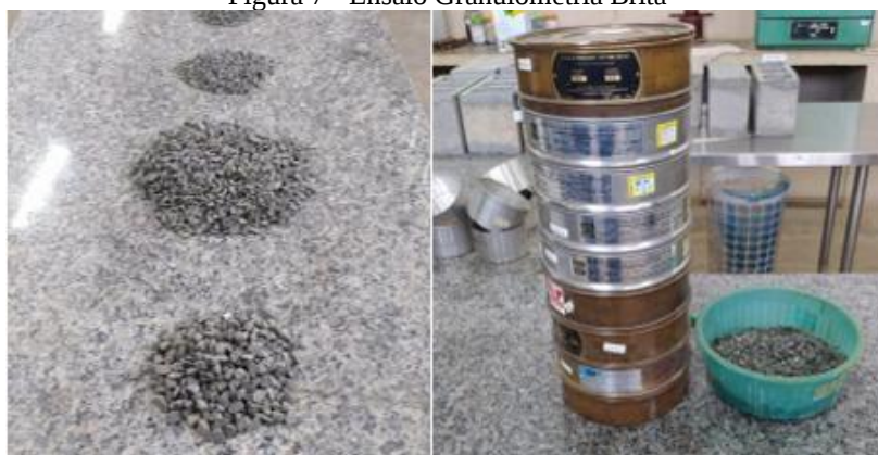
Figura 7 - Ensaio Granulometria Brita
