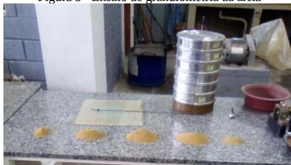
Figura 5 - Ensaio de granulometria da areia
